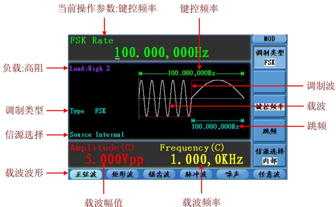
图 5-17: 频移键控调制的用户界面
