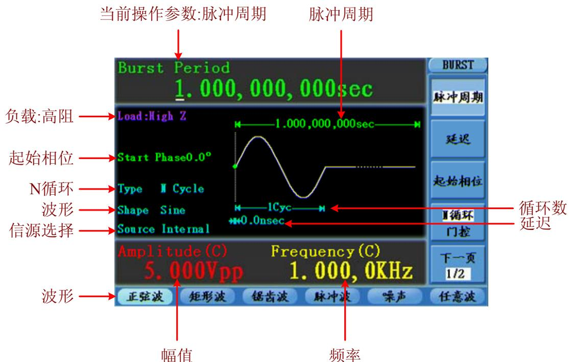
图 5-20: N 循环脉冲串的用户界面
