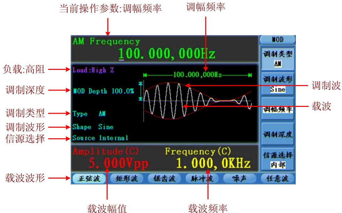
图 5-14：振幅调制的用户界面
