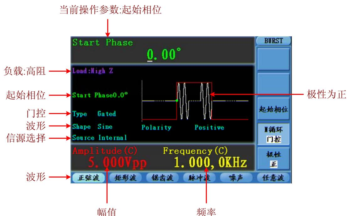
图 5-21：门控脉冲串的用户界面
