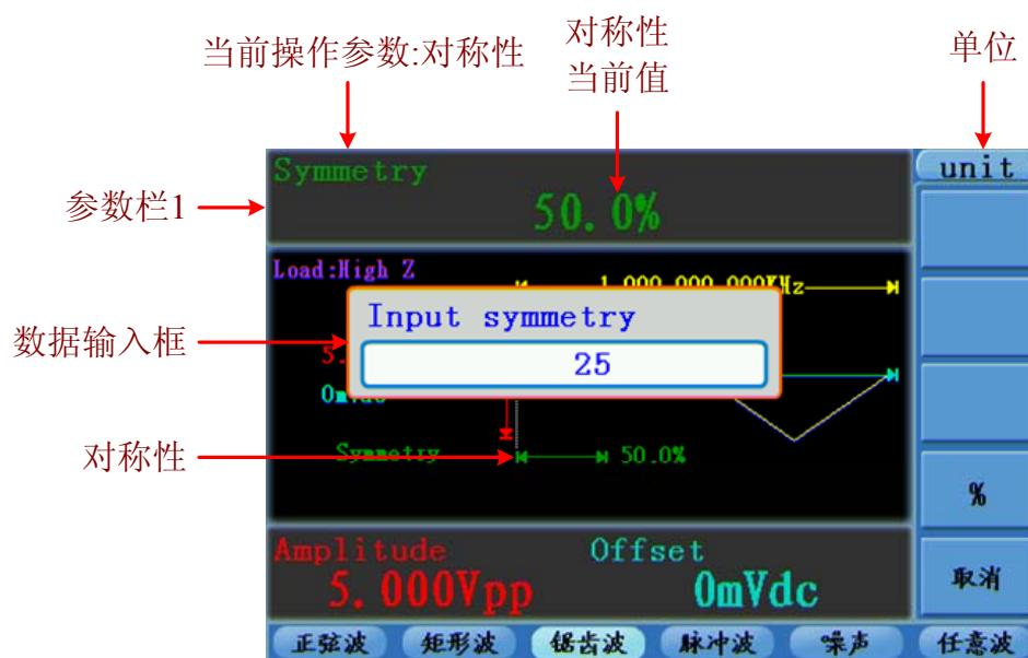
图 5-6: 设置锯齿波的对称性
